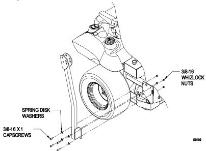
FIGURE 2 LOWER ROLL BAR INSTALLATION
